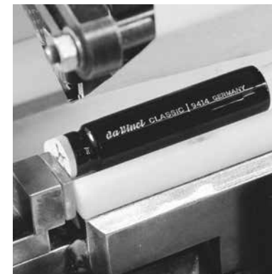
7. Stempeln der Holzstiele Stamping the wooden handles
